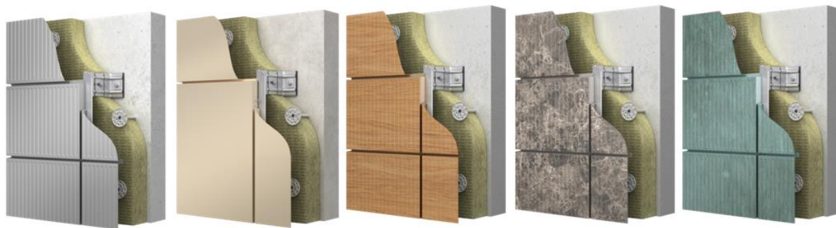
Рисунок 6.6 - Конструктивное решение НФС с применением кассет МеталлТекс (на примере производителя Краспан)
